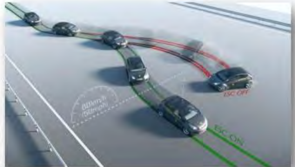
شکل ۹: تاثیر فناوری پایداری الکترونیکی در افزایش پایداری خودرو
