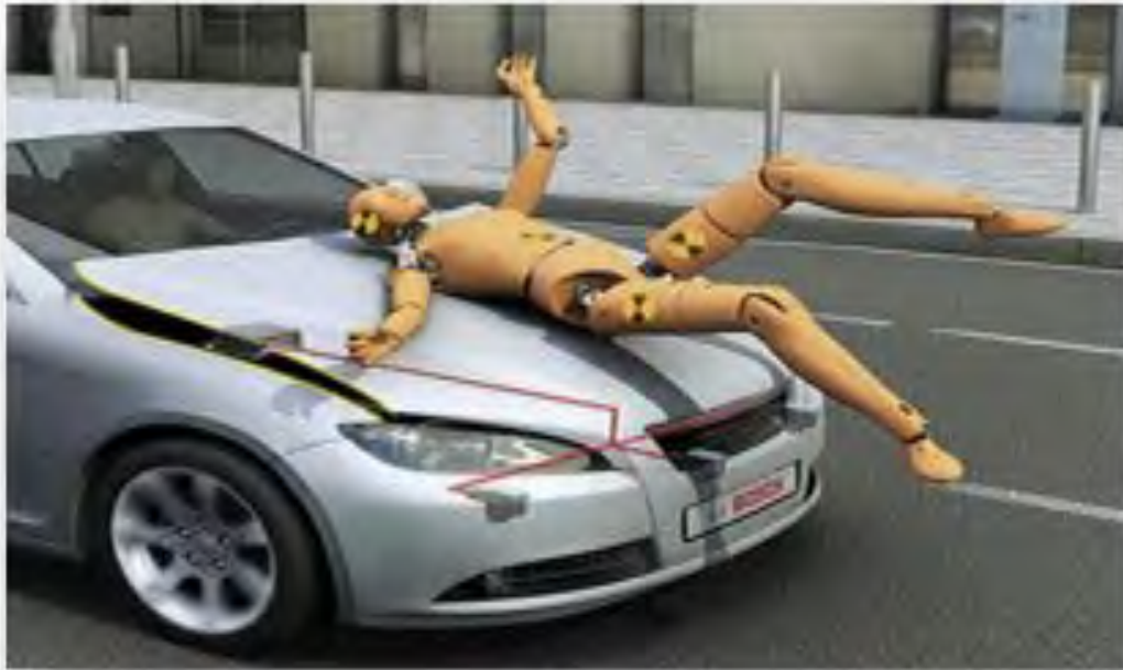
شکل ۱۳: سیستم حفاظت از عابر پیاده به هنگام تصادف
