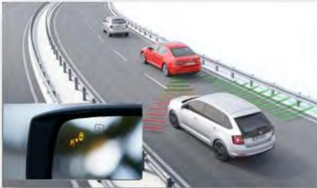
شکل ۱۰: نحوه عملکرد سیستم پایش نقاط کور خودرو
